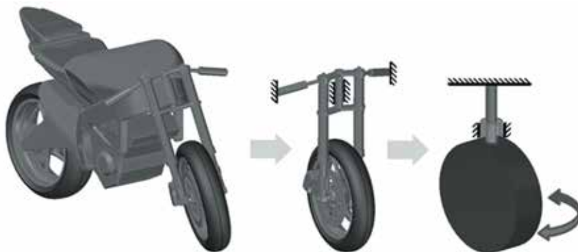
Rys. 1. Koncepcja modelu zastępczego służącego testowaniu procedur numerycznych
